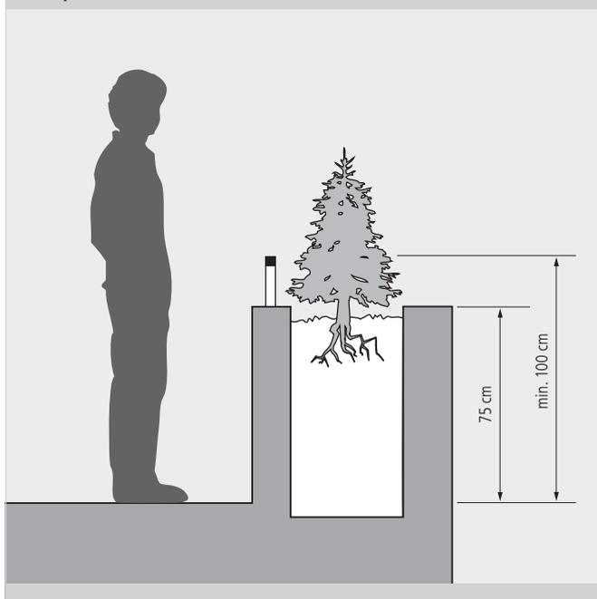
Per arredare le terrazze sui tetti si usano spesso fioriere. Per garantire la sicurezza, l'upi raccomanda un'altezza di 75 cm per le fioriere. Inoltre, sul lato dell'utente e su un'altezza di almeno 100 cm va montata una traversa orizzontale.
